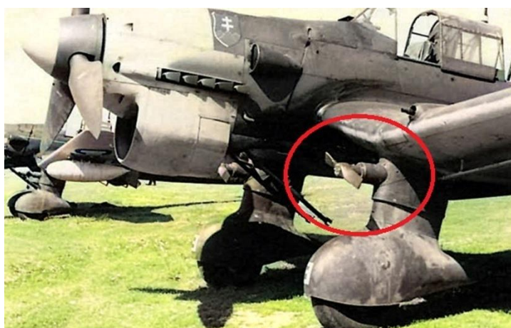
Fig. 1.- Detalle de las pequeñas hélices conocidas como “Trompeta de Jericó” instalada sobre la carena del tren de aterrizaje en un modelo Stuka de la II Guerra Mundial (Trevithick, 2020).
